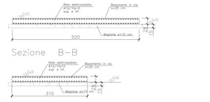
BASAMENTO PER COMPRESSORE Pianta
