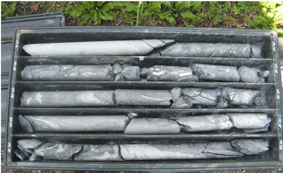
Figura 11 – Sondaggio L2S06 in fase di P.E. profondità da 30m a 35m.
