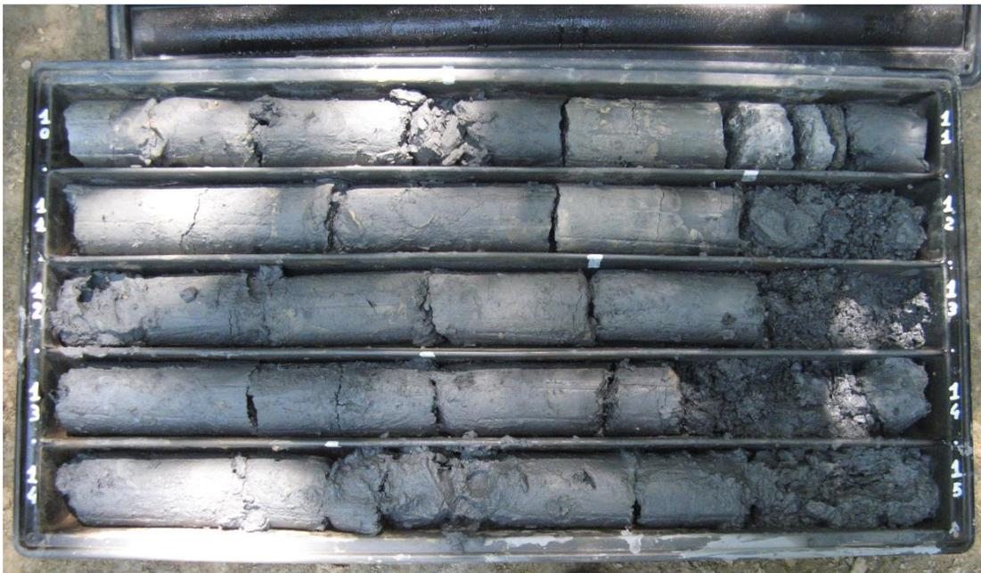
**Figura 7 – Sondaggio L2S06 in fase di P.E. profondità da 10m a 15m.**
