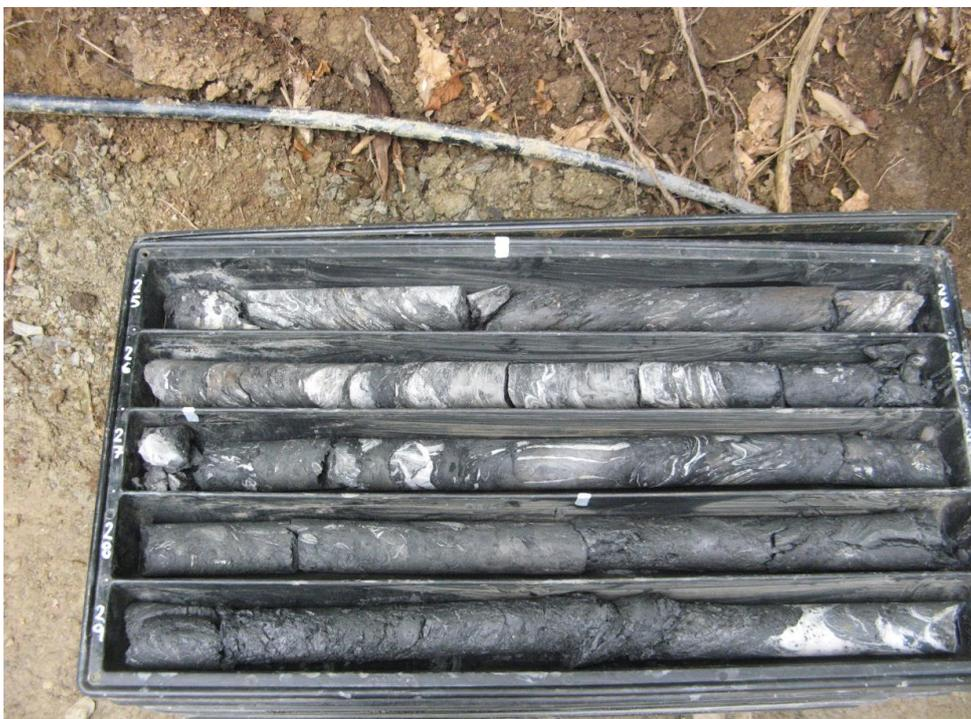
**Figura 10 – Sondaggio L2S06 in fase di P.E. profondità da 25m a 30m.**
