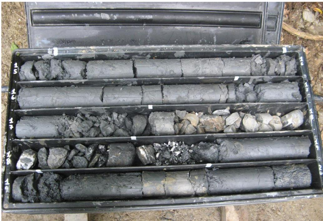
**Figura 8 – Sondaggio L2S06 in fase di P.E. profondità da 15m a 20m.**
