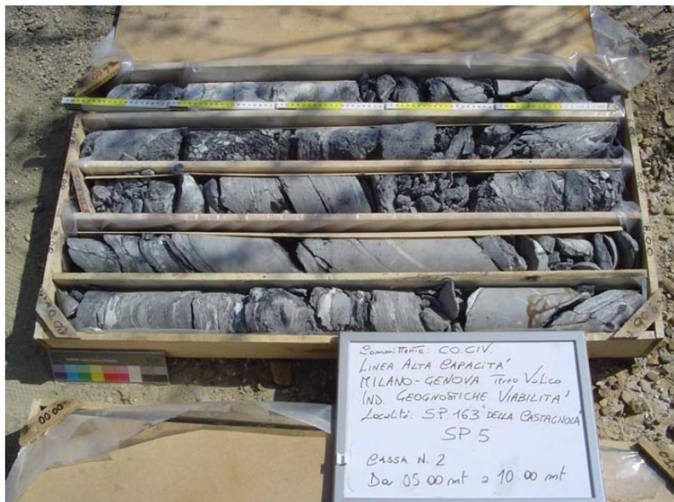
Figura 5 – Sondaggio SP5 in fase di P.D. profondità da 0m a 10m.
