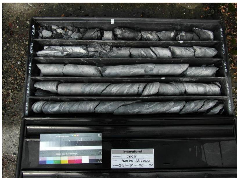
**Figura 14 – Sondaggio L2S31 in fase di P.E. profondità da 145m a 150m.**
