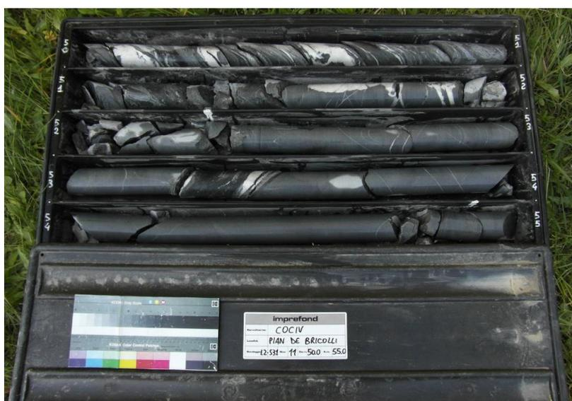
**Figura 12 – Sondaggio L2S31 in fase di P.E. profondità da 50m a 55m.**
