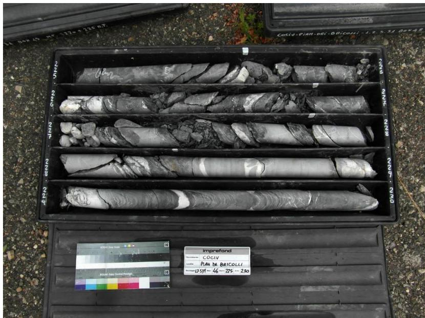
Figura 16 – Sondaggio L2S31 in fase di P.E. profondità da 225m a 230m.
