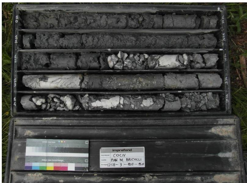
**Figura 11 – Sondaggio L2S31 in fase di P.E. profondità da 10m a 15m.**
