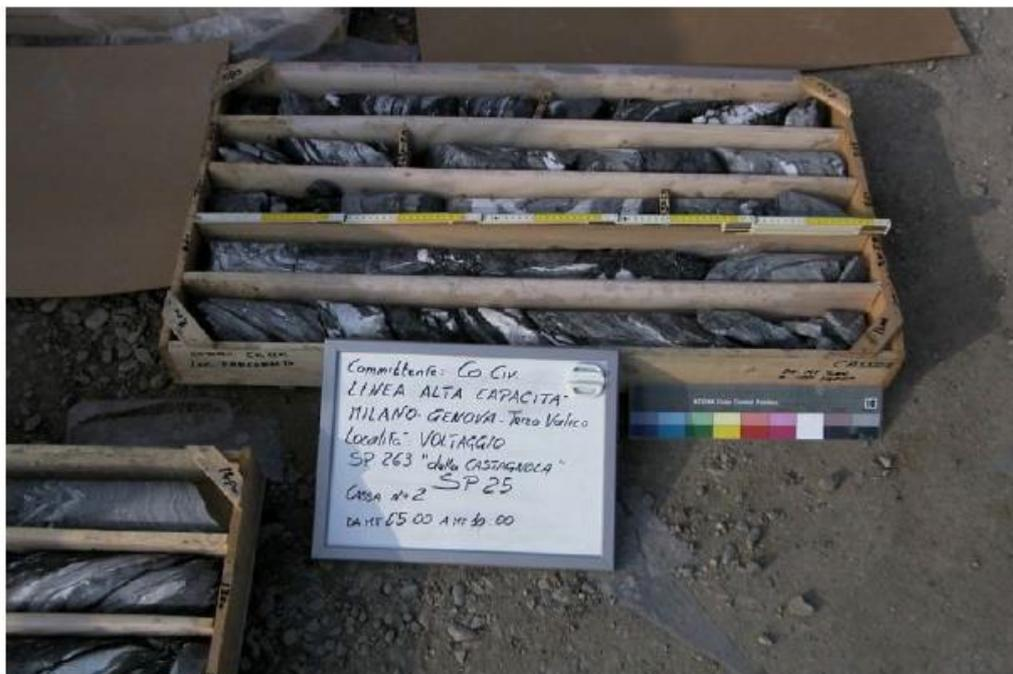
**Figura 7 – Sondaggi SP25 in fase di P.D. profondità da 0m a 10m.**
