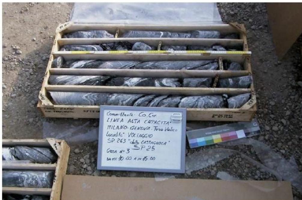
**Figura 8 – Sondaggio SP25 in fase di P.D. profondità da 10m a 15m.**
