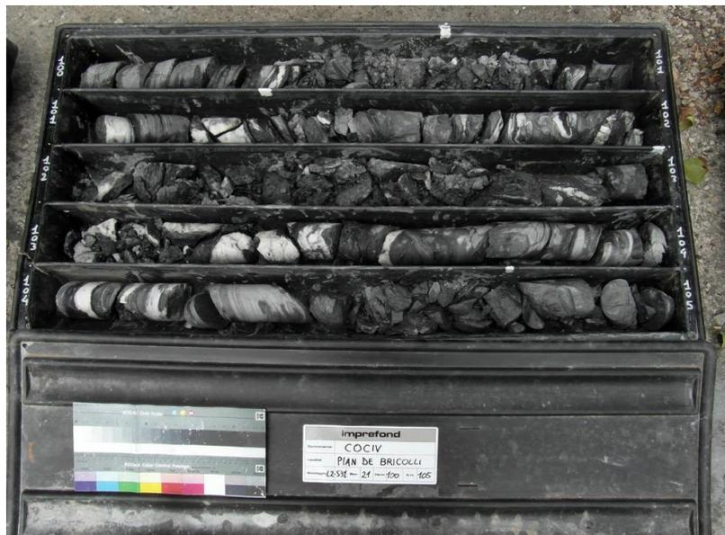
**Figura 13 – Sondaggio L2S31 in fase di P.E. profondità da 100m a 105m.**
