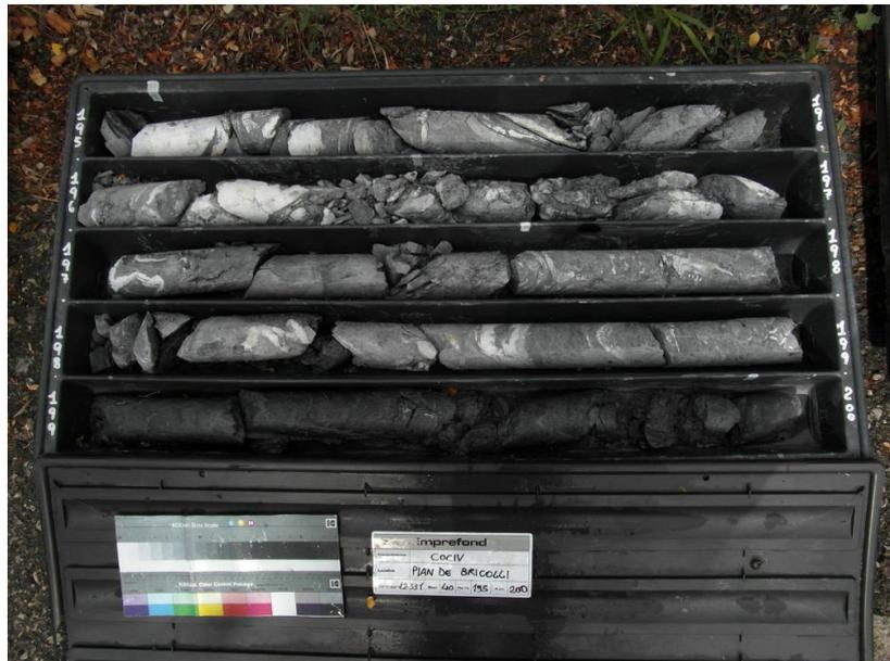
Figura 15 – Sondaggio L2S31 in fase di P.E. profondità da 195m a 200m.
