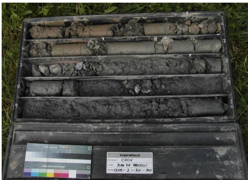
Figura 10 – Sondaggio L2S31 in fase di P.E. profondità da 5m a 10m.
