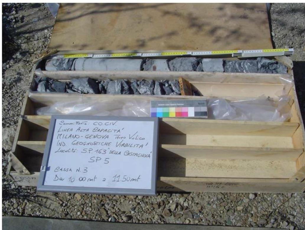
Figura 6 – Sondaggio SP5 in fase di P.D. profondità da 10m a 11.5m.
