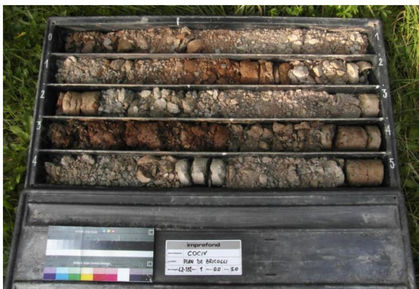
Figura 9 – Sondaggio L2S31 in fase di P.E. profondità da 0m a 5m.
