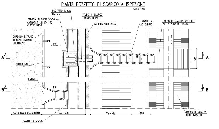
DRENAGGIO MARGINALE PER BARRIERA ANTIFONICA CON CANALA LONGITUDINALE CONTINUA APERTA E SCARICO CON EMBRICI
