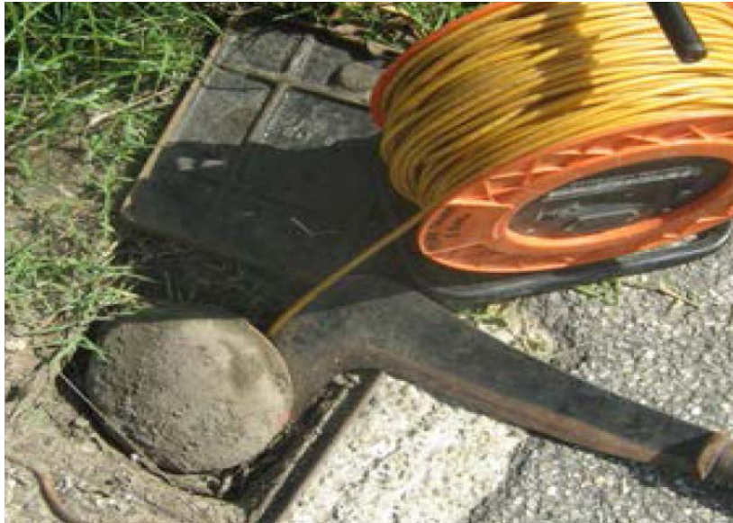
Figura 6: Misurazioni all'interno del piezometro 30
