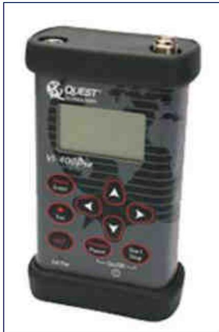
**Figura 6 – Analizzatore di vibrazioni QUEST VI 400 Pro**
