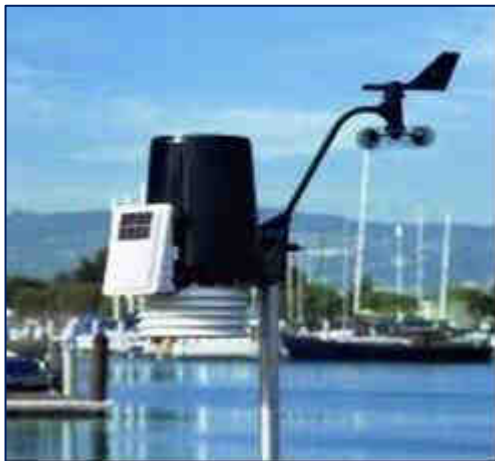
Figure 4/5 – Centralina Meteo tipo Davis affiancata al Fonometro
