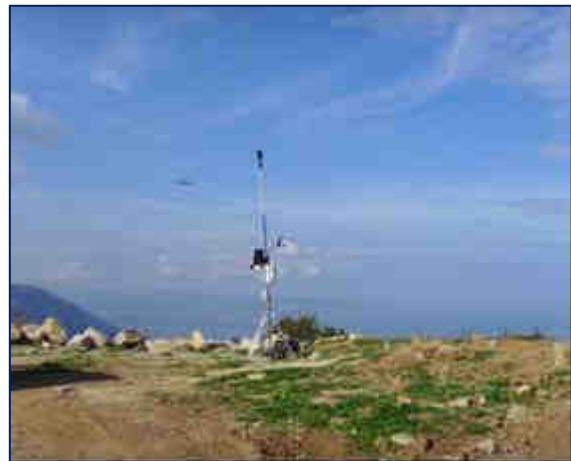
Figure 4/5 – Centralina Meteo tipo Davis affiancata al Fonometro
