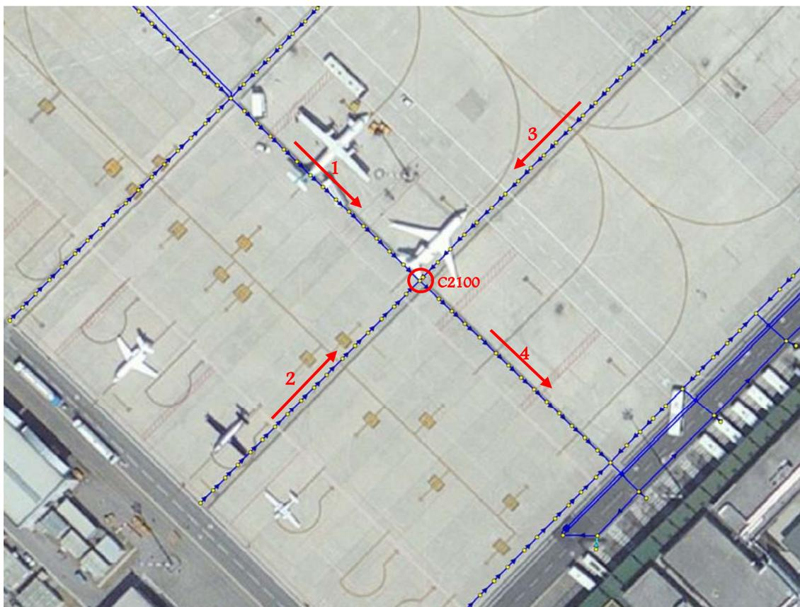
Figura 17. Funzionamento della rete di prima raccolta in prossimità dell'area soggetta ad allagamento.
