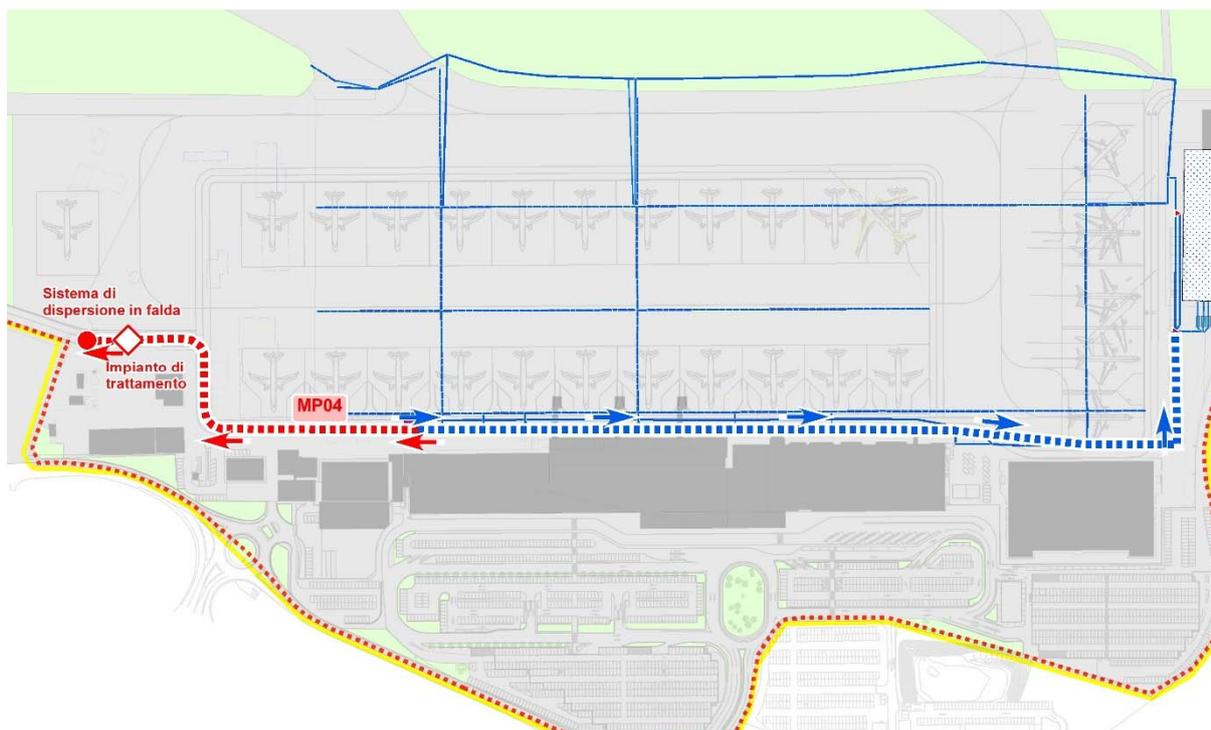
Figura 53. Intervento MP.04 – Nuova dorsale di collettamento acque meteoriche ampliamento piazzale aeromobili: fase 1.
