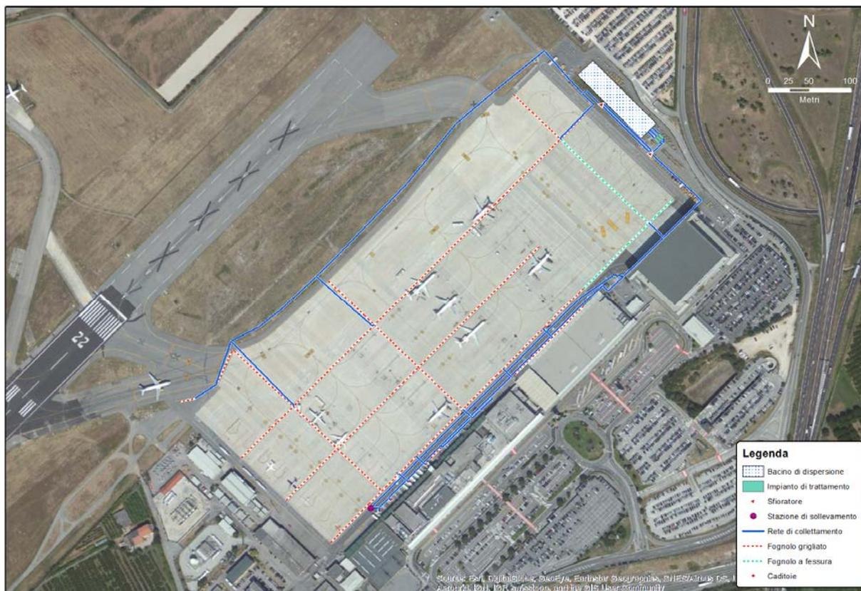
Figura 6. Rete di collettamento, impianto di trattamento e bacino di dispersione del piazzale aeromobili.
