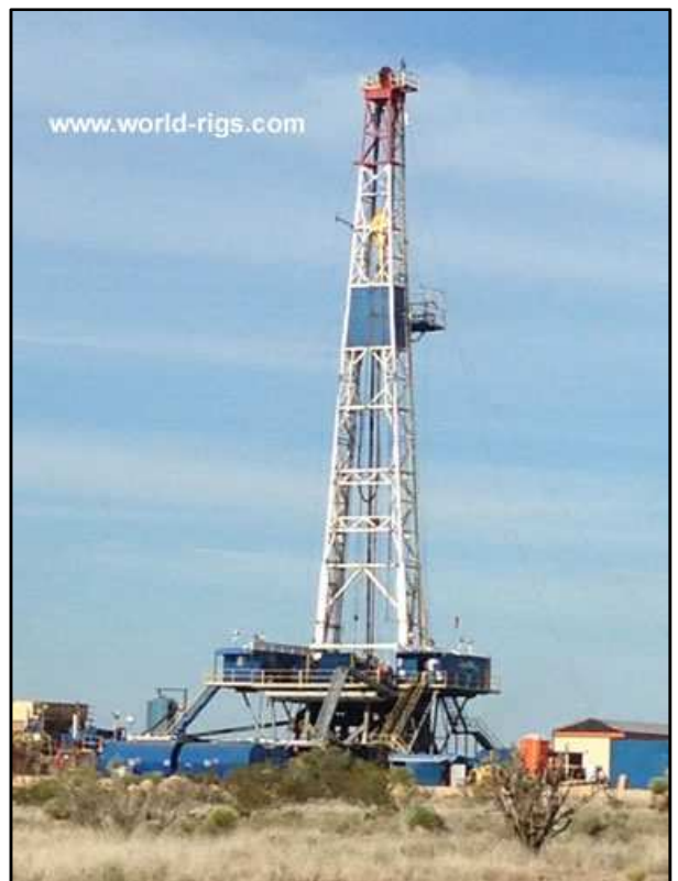
Fig. 7 - Esempio di impianto di perforazione National 1320 (foto tratta dal web)
