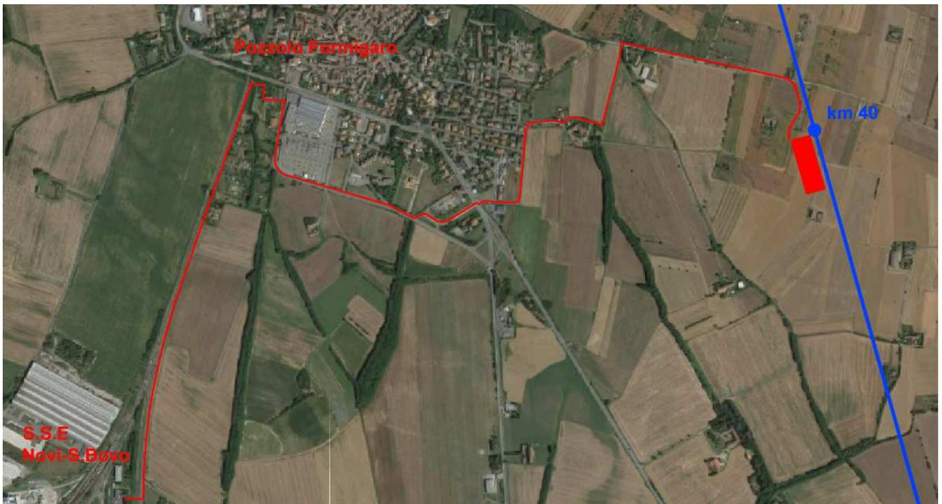
Figura 5-2 Percorso del cavidotto 132 kV e ubicazione della nuova SSE
