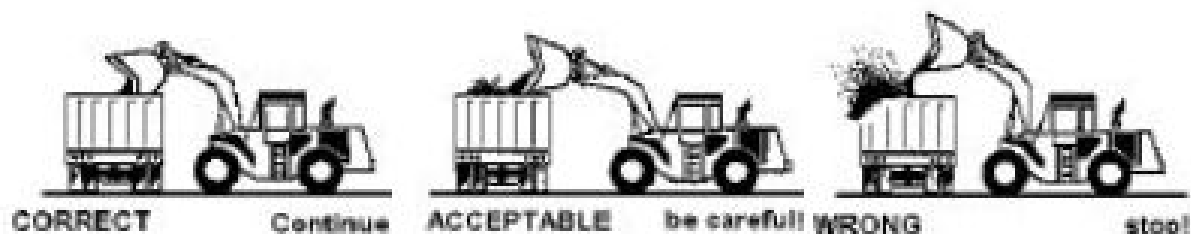
Figura 3-10 – Corrette procedure per il carico dei camion
