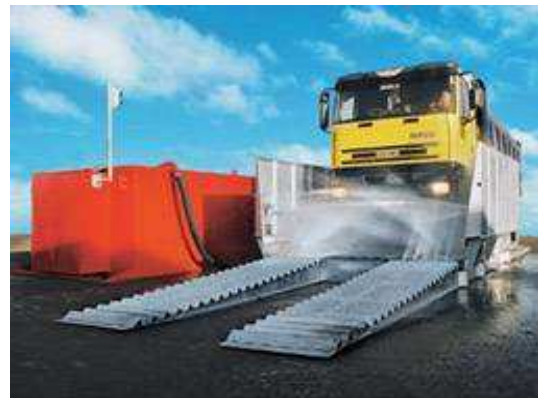
Figura 3-7 - Sistemi per il lavaggio dei pneumatici
