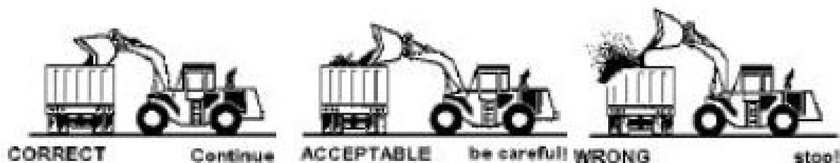
**Figura 3-10 – Corrette procedure per il carico dei camion**
