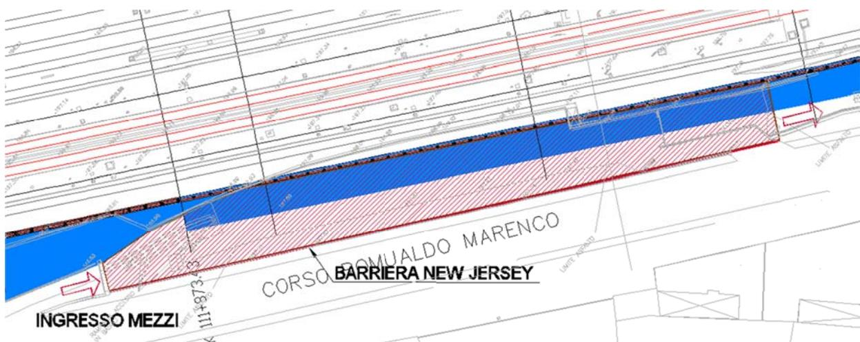
L'area di cantiere "Stoccaggio Materiali" è collocata all'interno dell'area stoccaggio traverse della ferrovia, con l'accesso su Via San Giovanni Bosco, e presenta uno sviluppo di circa 5450m<sup>2</sup>. In tale area è previsto lo stoccaggio dei materiali e delle attrezzature necessarie per la realizzazione delle opere previste da progetto.
