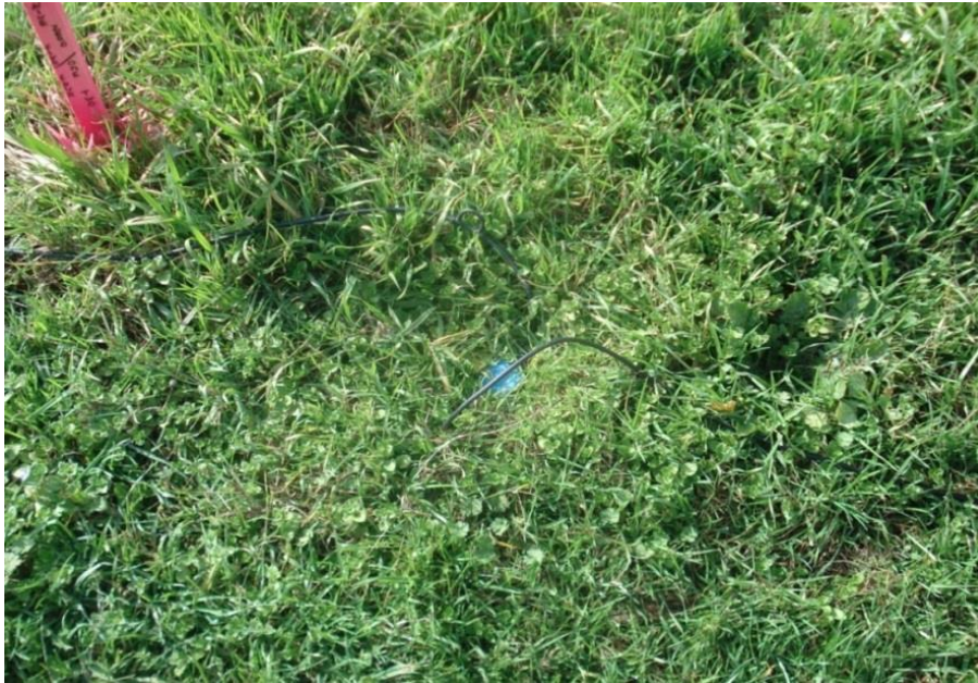
Figura 9 - Geofono posizionato in prossimità del picchetto identificativo del punto di ubicazione.
