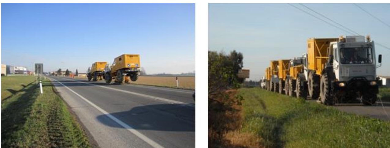
Figura 12 - Autocarri Vibroseis durante la fase di energizzazione.
