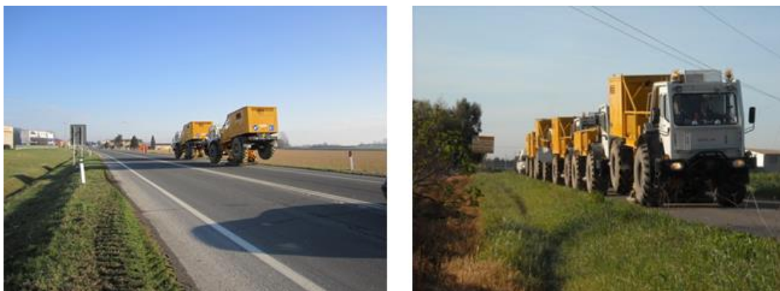
Figura 3.e: Vibroseis in Fase di Energizzazione
