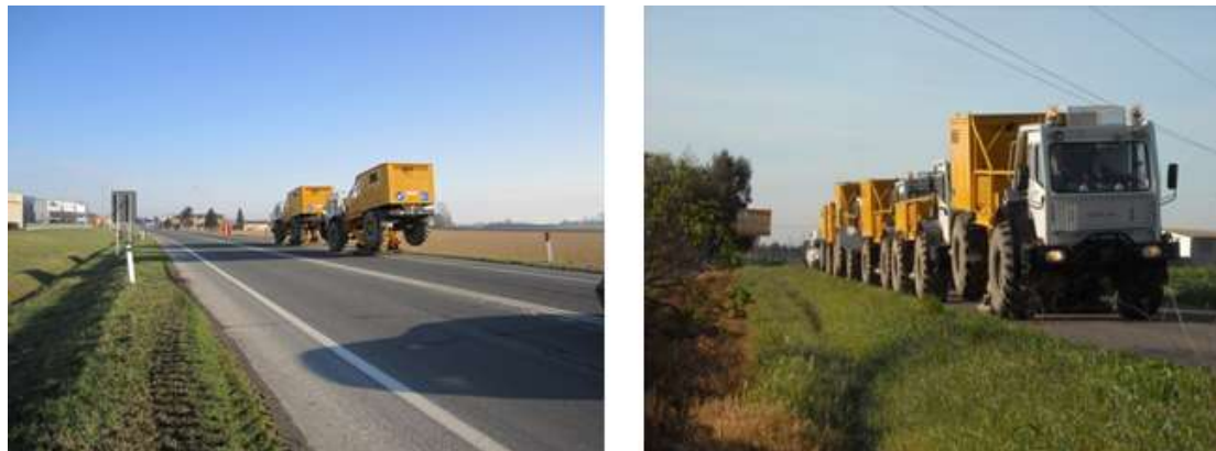
Figura 3.d: Vibroseis in fase di Energizzazione
