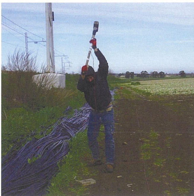
Energizzazione Prova MASW
