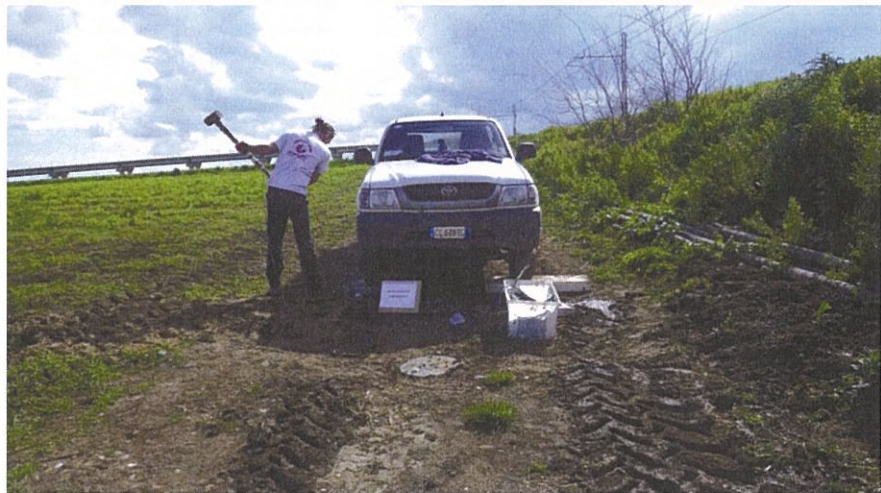
Energizzazione Onde S
