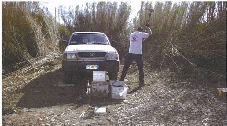
Energizzazione Onde S
