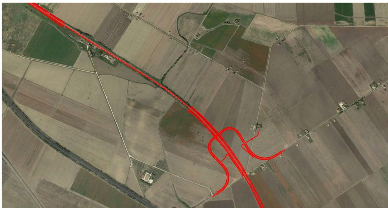
*Figure 4-11: Il tracciato del nuovo viadotto Ripalta e i rilevati tra questo e l'attraversamento del Fortore e le aree marginalizzate in corrispondenza dell'interferenza con la strada comunale di Fischino.*
