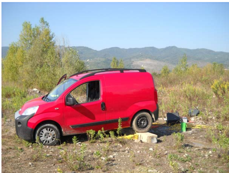
Figura 2 Evidenza del punto di energizzazione con onde S
