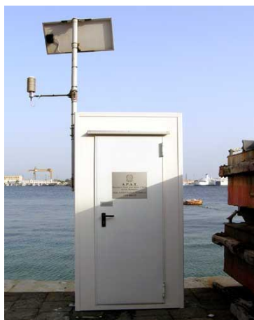
Figura 3.6 – Stazione di misura mareografica di Messina.
