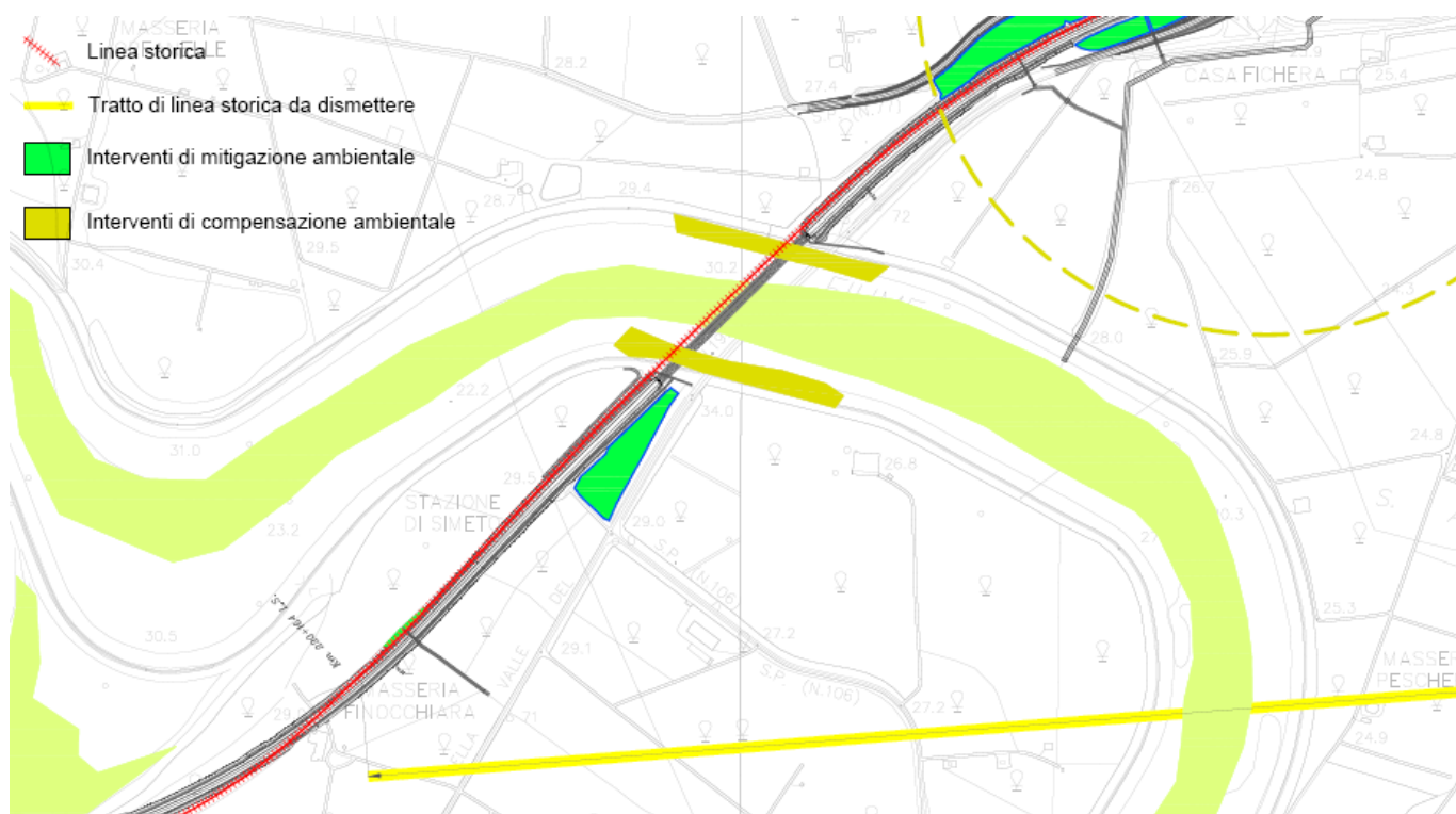
Figura 16 - Attraversamento area ad Alta Permeabilità della Rete Ecologica della Provincia di Catania Assetto progettuale (con viadotto) e interventi di mitigazione e compensazione ambientale (stralcio della "Planimetria degli interventi "a verde" RSOK 10 F22 P5 IA0000 001 - 9A)
