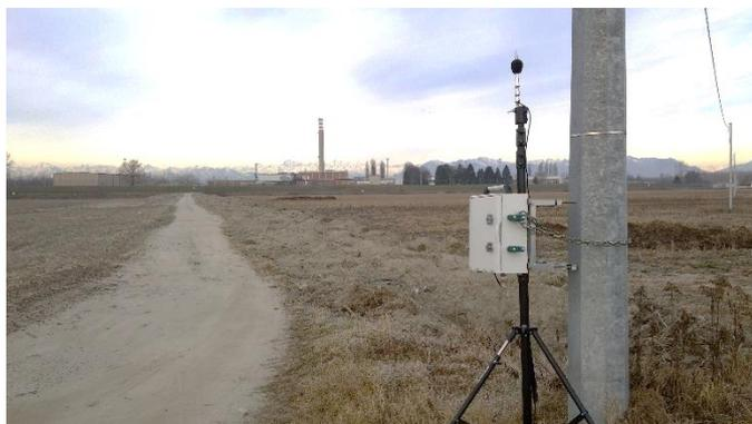
Figura 6-3 Stazione fissa di monitoraggio presso il punto ricettore
