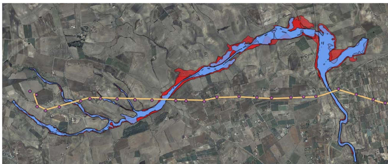
Figura 11 – Tratti fluviali del bacino Gravina di Castellaneta - Confronto delle perimetrazioni delle aree allagate ottenute per portate con T_R = 200 anni calcolate con diverse condizioni iniziali di saturazione dei suoli al verificarsi dell'evento meteorico (AMC): in blu CN(I), in rosso CN(II).
