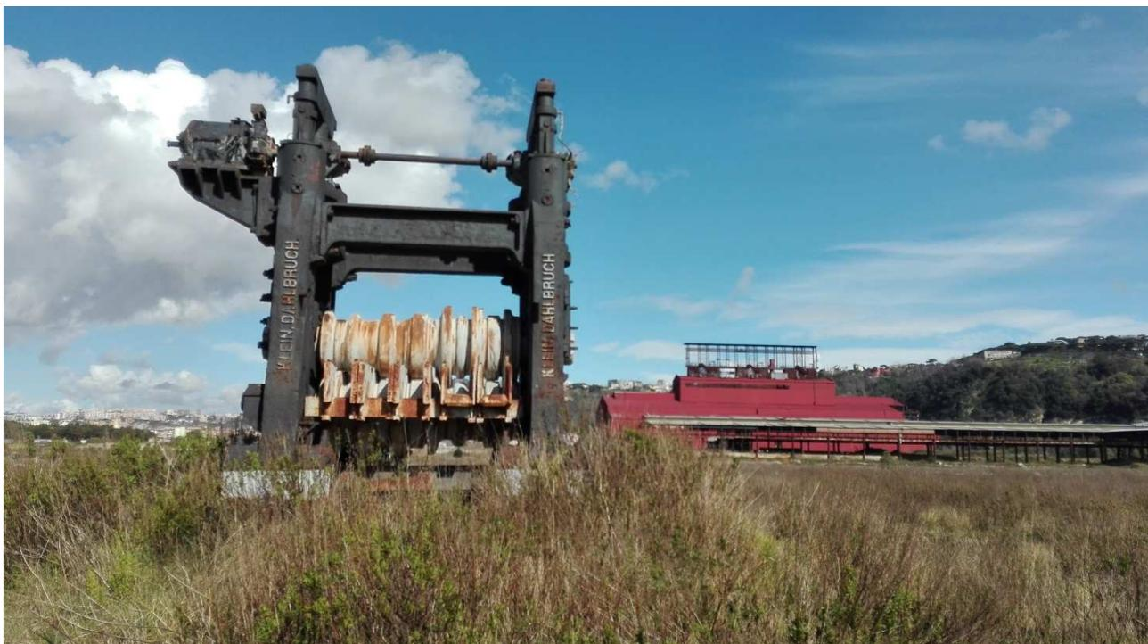
Utilizzata fino alla dismissione del 1990, faceva parte del treno di laminazione. A struttura interamente metallica, la gabbia VSB, mediante un sistema di rulli e getti d'acqua a elevata pressione, era utilizzata per effettuare una prima pulitura superficiale della bramma prodotta in acciaieria, dove, smontata, si trova oggi ricoverata. Tutti gli elementi presentano un stato più o meno diffuso di degrado dovuto a fenomeni di ossidazione e corrosione del materiale
