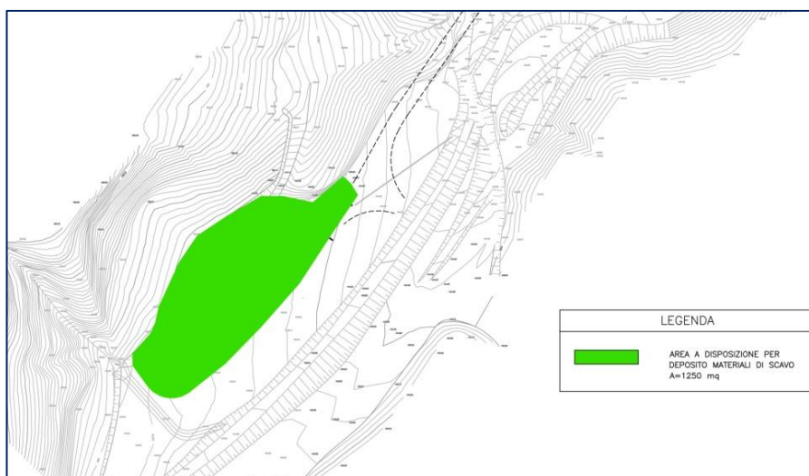
Aggiornamento Layout “DDP1 - Cantiere Operativo Castagnola NV22” (DPPB)
