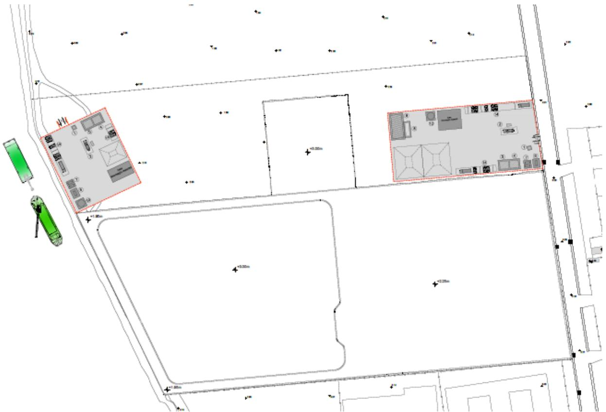
**Figura 3.1: Ubicazione delle aree logistiche di cantiere**
