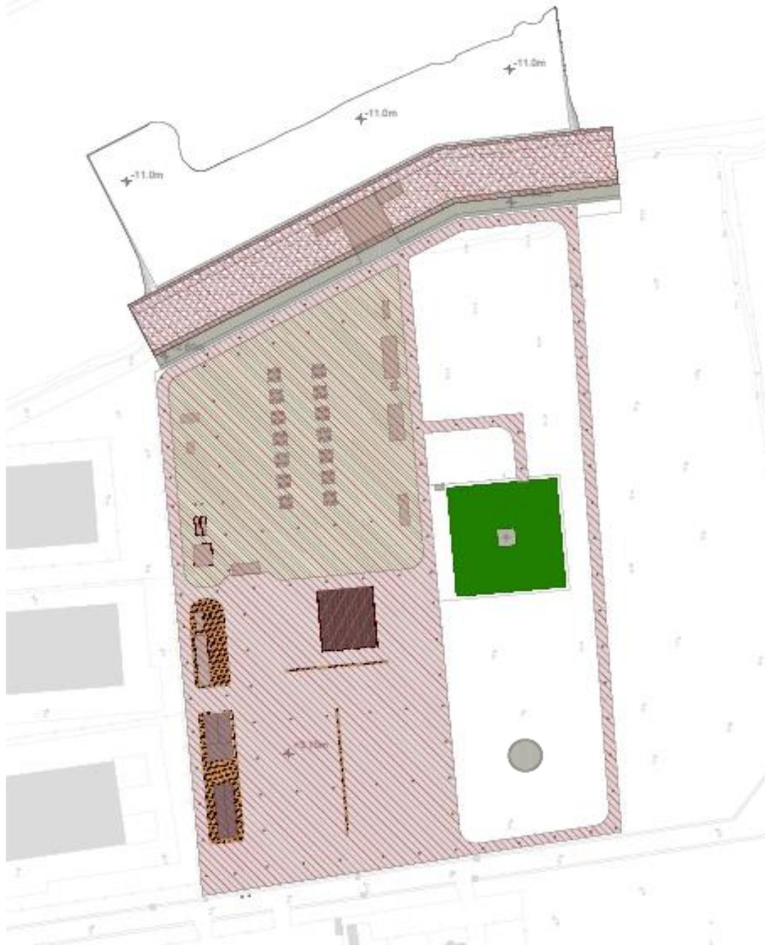
**Figura 2.5: Fase 5 completamento e sistemazione superficiale area impianto**
