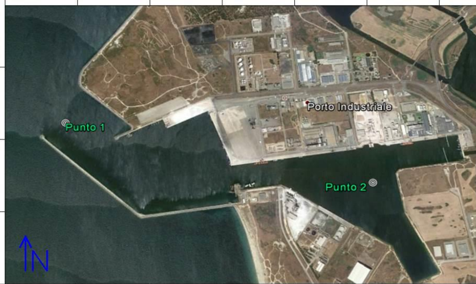
Figura 6.4: Punti di Calcolo delle Onde Estreme Locali
