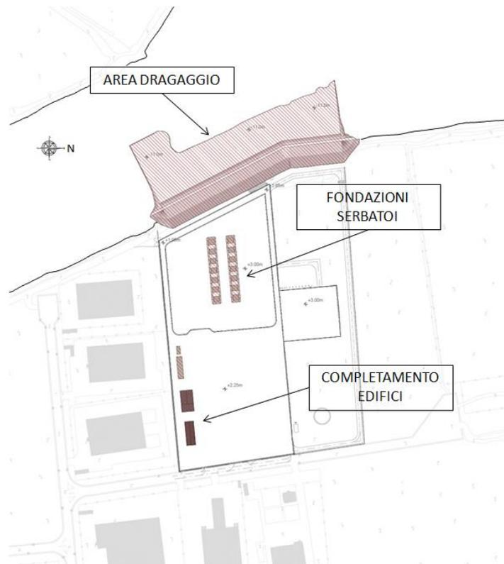
**Figura 3.5: Completamento degli Edifici, delle Fondazioni dei Serbatoi e delle Operazioni di Dragaggio (Fase 3)**
