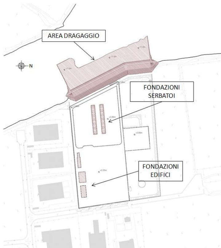
**Figura 3.4: Realizzazione delle Fondazioni degli Edifici, Esecuzione dei Pali di Fondazione dei Serbatoi e Avvio delle Operazioni di Dragaggio (Fase 2)**
