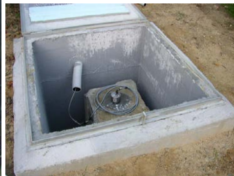
Fig. 24: esempio di alloggiamento della strumentazione nell'armadietto e del sensore all'interno del pozzetto.
