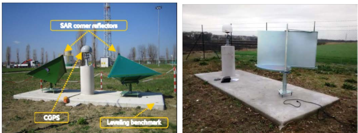
Fig. 29: S.S.U. Satellite Survey Unit.
