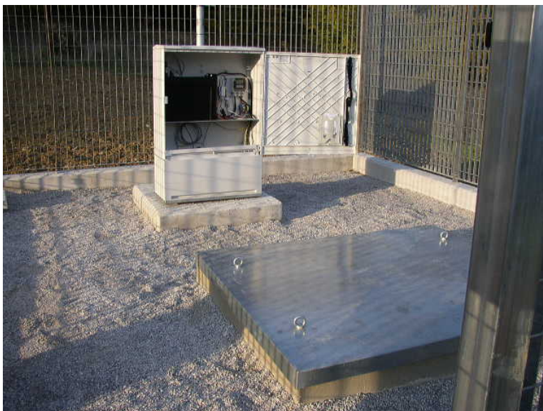
Fig. 24: esempio di alloggiamento della strumentazione nell'armadietto e del sensore all'interno del pozzetto.
