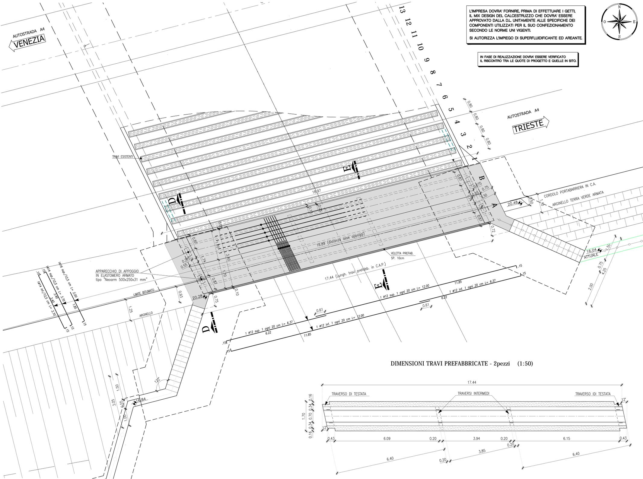
L'IMPRESA DOVRA' FORNIRE, PRIMA DI EFFETTUARE I GETTI, IL MIX DESIGN DEL CALCESTRUZZO CHE DOVRA' ESSERE APPROVATO DALLA D.L. UNITAMENTE ALLE SPECIFICHE DEI COMPONENTI UTILIZZATI PER IL SUO CONFEZIONAMENTO SECONDO LE NORME UNI VIGENTI.
