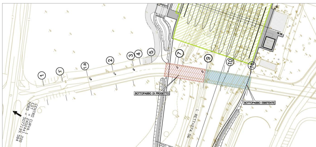
Fig. 16 – Planimetria impalcato: in rosso di progetto, in blu esistente.
