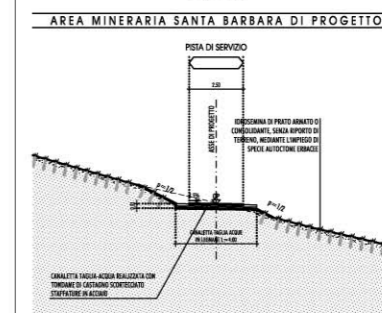
PISTA DI SERVIZIO SEZIONE TIPO ATTRAVERSAMENTO CON TAGLIA-ACQUA SCALA 1:100
