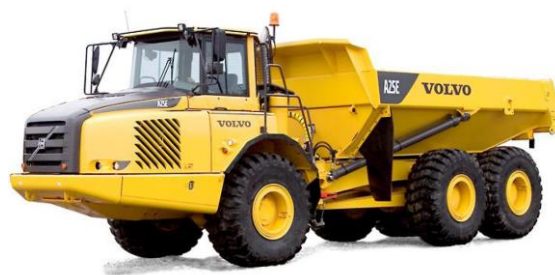
Figura 2 – Veicolo tipo per movimenti terra su piste dorsali di cantiere
