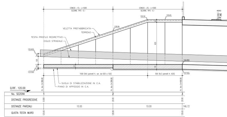
SEZIONE LONGITUDINALE - MURI DI USCITA LATO SINISTRA - SCALA 1:100
