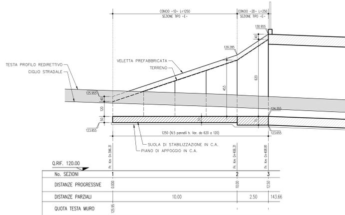
SEZIONE LONGITUDINALE - MURI DI IMBOCCO LATO DESTRO - SCALA 1:100
