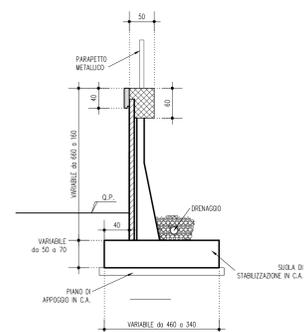
SEZIONE TIPOLOGICA MURO SPARTITRAFFICO SAGOMATO
