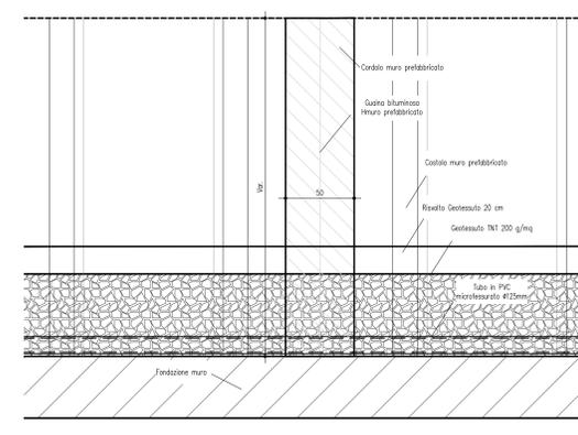
SEZIONE TIPOLOGICA MURO SPARTITRAFFICO
