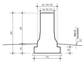
SEZIONE TIPOLOGICA MURO SPARTITRAFFICO SAGOMATO
