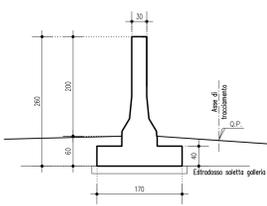
SEZIONE TIPOLOGICA MURO SPARTITRAFFICO
