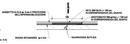
**DETTAGLIO GIUNTO STRUTTURALE PARETE SEZIONE X-X**
