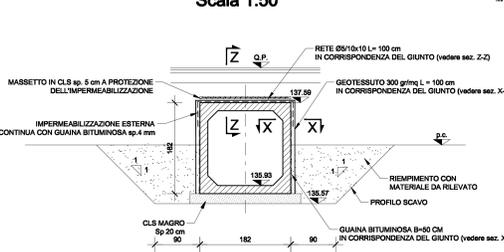
**DETTAGLIO GIUNTO STRUTTURALE SOLETTA SUPERIORE SEZIONE Z-Z**
