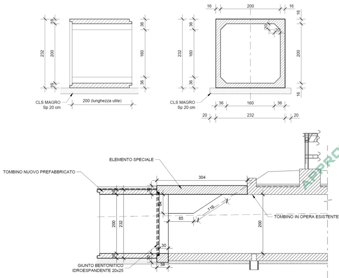
L'altezza di ricoprimento dello scatolare assunta ai fini del calcolo della struttura è pari a 0.81m.
