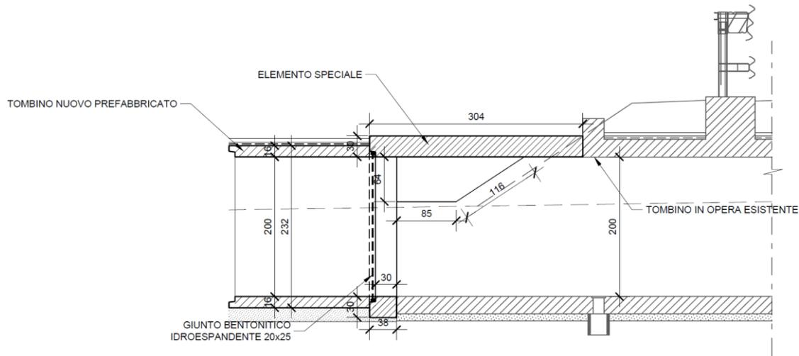
Il dimensionamento dell'elemento speciale di collegamento viene effettuato sulla base delle misure dedotte dall'elaborato grafico riportate nel seguito:
