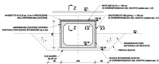
DETTAGLIO GIUNTO STRUTTURALE
