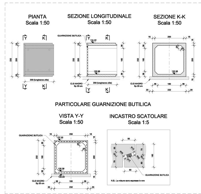
DETTAGLIO GIUNTO STRUTTURALE
