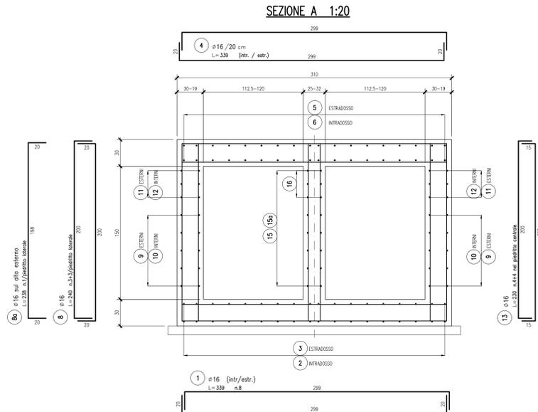
SCHEMA CHIODATURE ALLA STRUTTURA ESISTENTE 1:20
