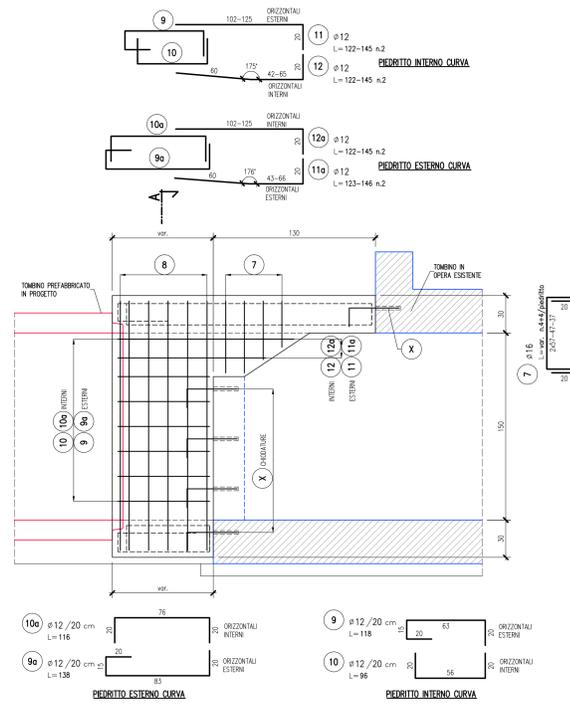
SCHEMA CHIODATURE ALLA STRUTTURA ESISTENTE 1:20
