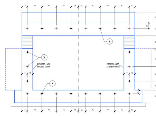
DETTAGLIO CHIODATURA ALLA STRUTTURA ESISTENTE 1:10
