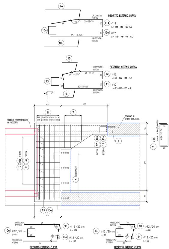
SCHEMA CHIODATURE ALLA STRUTTURA ESISTENTE 1:20
