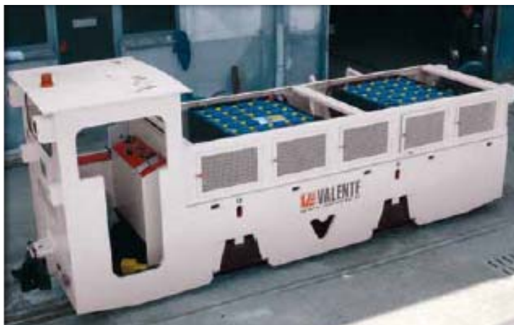
locomotore a trazione elettrica (pacchi batterie ricaricabili anteriori)
