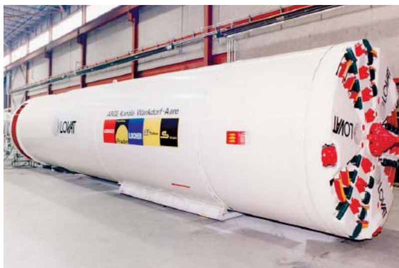
esempio di TBM per lo scavo della galleria
