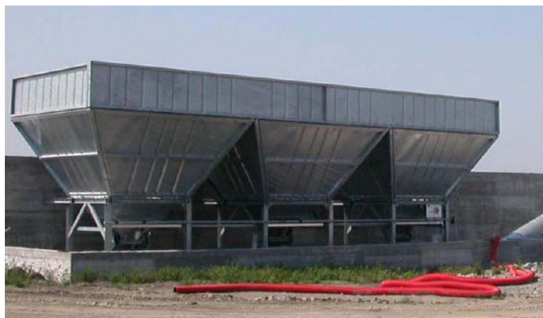
tramogge di carico inerti
