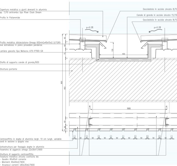
SEZIONE LONGITUDINALE D5 - DETTAGLIO GRONDA TRASVERSALE
