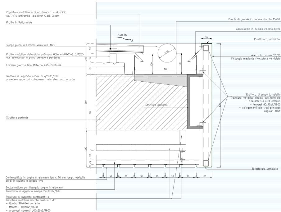
SEZIONE LONGITUDINALE D6 - DETTAGLIO SBALZO GRONDA TRASVERSALE
