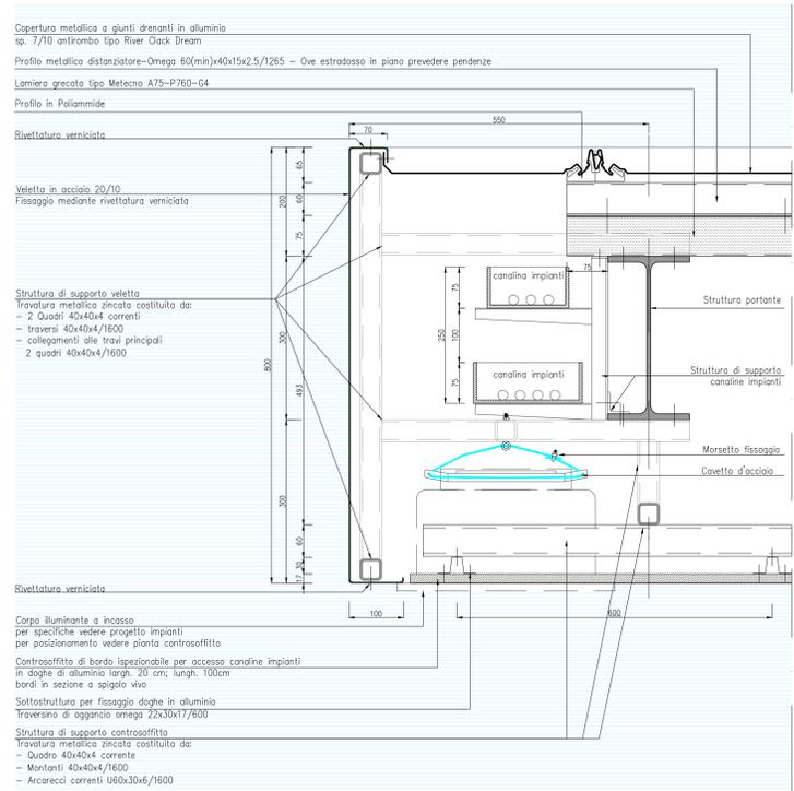
SEZIONE TRASVERSALE D1 - DETTAGLIO VELETTA LATERALE
