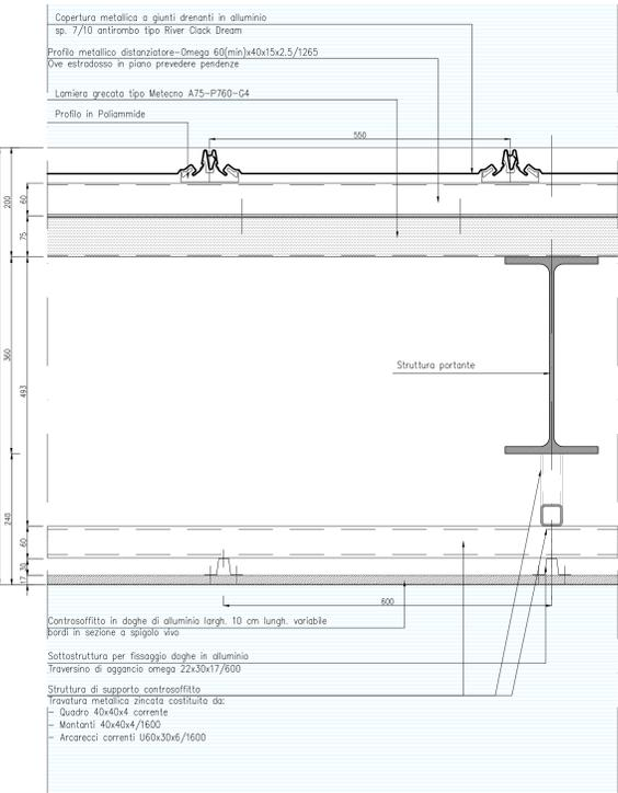
SEZIONE TRASVERSALE D2 - DETTAGLIO CORRENTE
