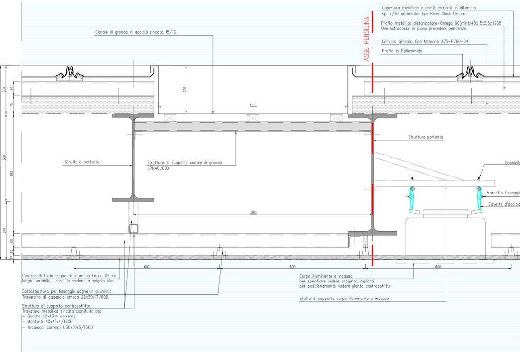
SEZIONE TRASVERSALE D3 - DETTAGLIO GRONDA LONGITUDINALE
