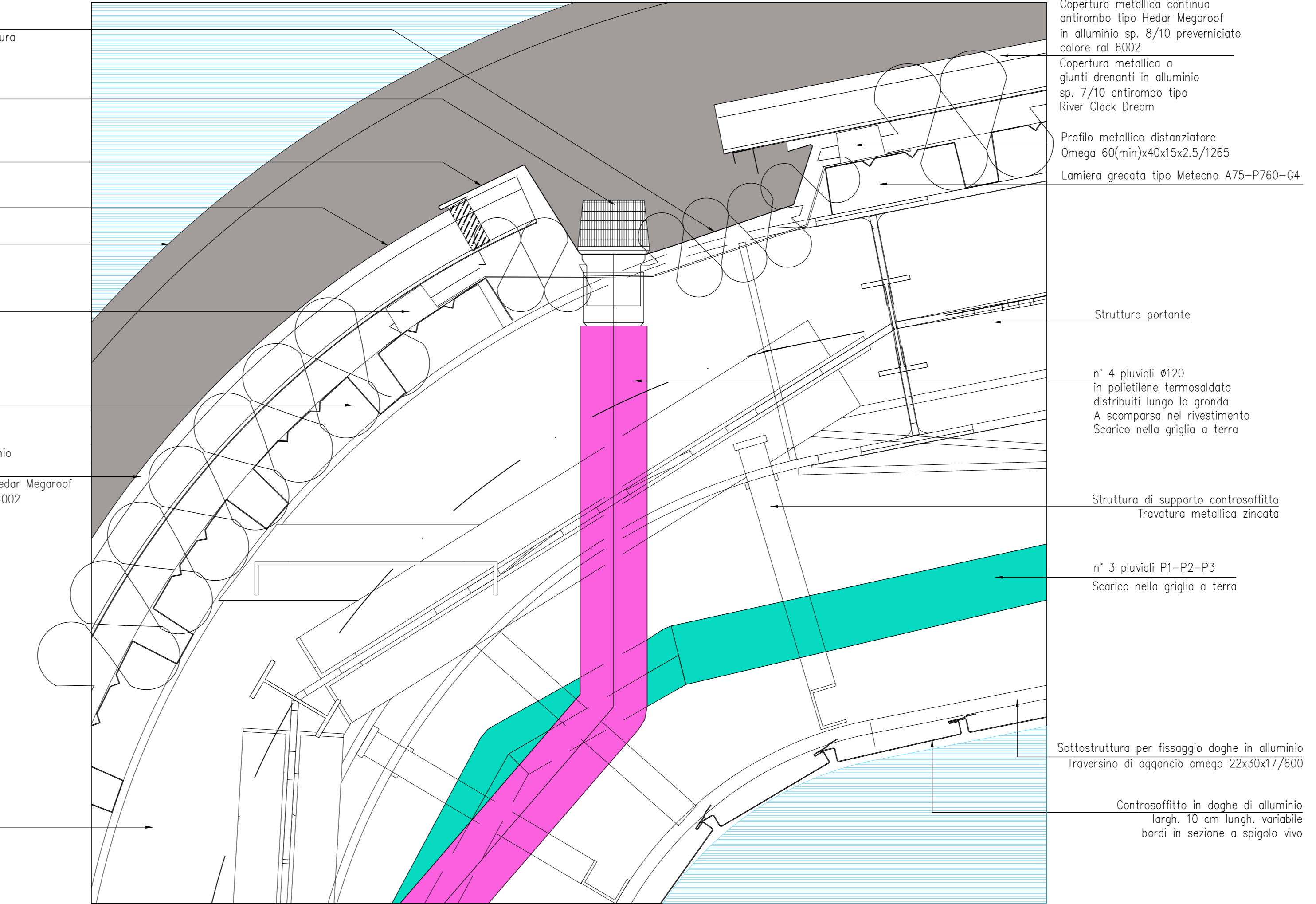
SEZIONE TRASVERSALE DETTAGLIO GRONDA DI RACCOLTA SCALA 1:5
