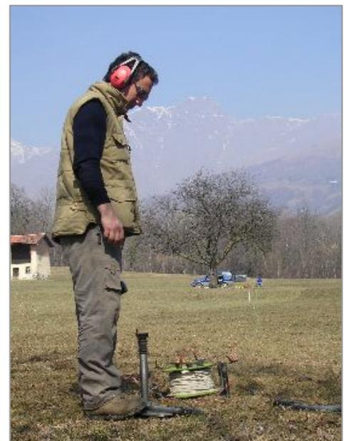
Per determinare con precisione, lungo lo stendimento, i dislivelli altimetrici tra le postazioni geofoniche ed i punti di energizzazione rispetto ad un punto di origine (tipicamente lo shot-point n.1), si e' eseguito un rilievo altimetrico di tipo relativo, mediante:
