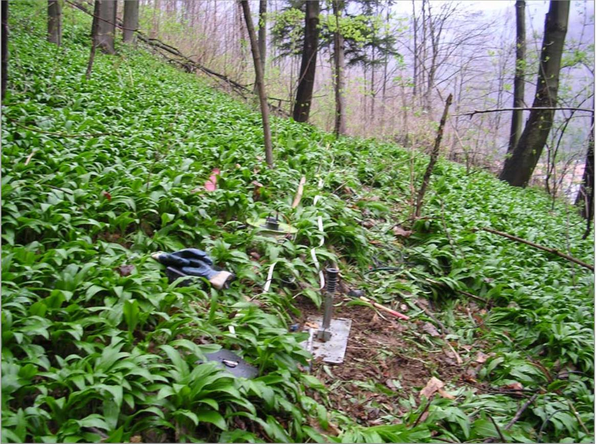
Stendimento sismico RS05: energizzatore sismico "Isotta" su posizione del tiro diretto
