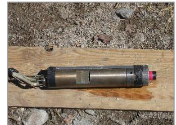
Per la determinazione delle esatte distanze orizzontali tra i due fori e' stata necessaria l'esecuzione di misure inclinometriche in foro, mediante:
