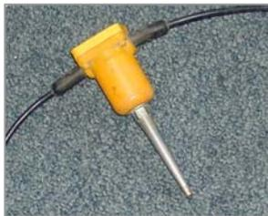
I geofoni verticali (tipo elettromagnetico a bobina mobile, frequenza caratteristica 10 Hz), consentono di convertire in segnali elettrici gli spostamenti che si verificano nel terreno; sono collegati al sismografo tramite degli appositi cavi multipolari a connessione rapida.
