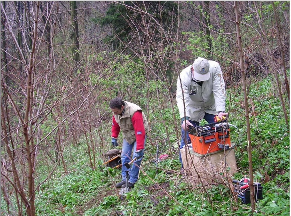
Stendimento sismico RS05: energizzazione centrale
