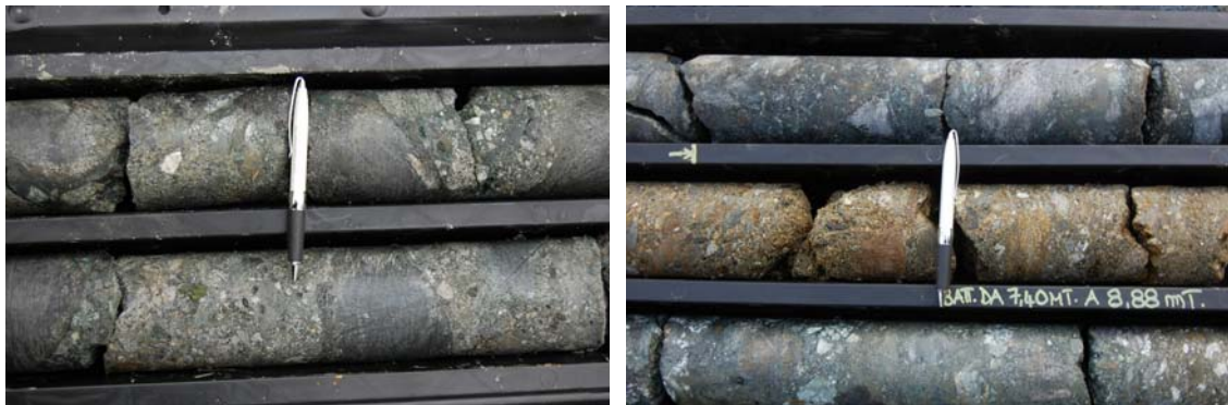
Foto 5.3 – Le breccie attraversate con i sondaggi SG5 e SG6
