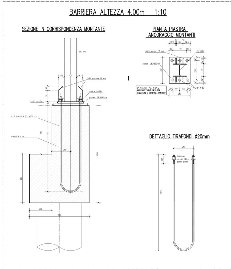
TIPOLOGICO PER BARRIERE SU MURO ESISTENTE BA1, BA2 (parte2)
