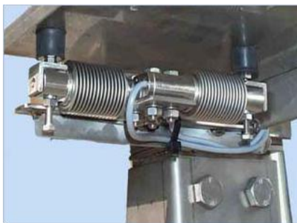
Figura 3.21: Quattro celle di carico per garantire una maggiore linearità di misurazione di tutta la gamma dei detriti
