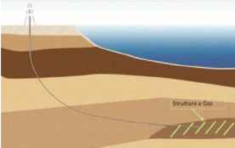
Figura 3. Lo schema con l'ubicazione del pozzo e del giacimento
